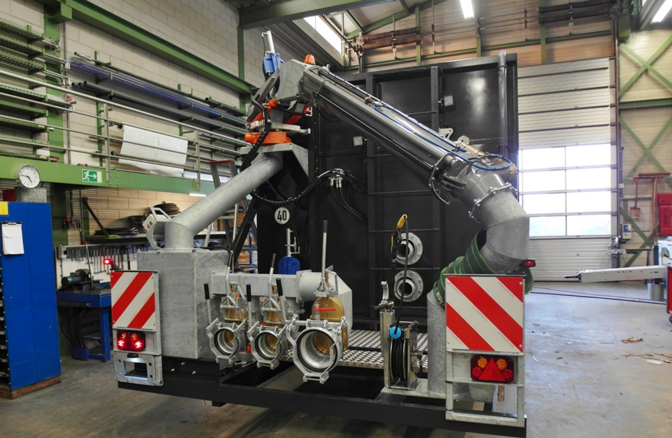
Schouten-Pumpcontainer-JC450 45 m 3 mit 4000 ltr. Kolbenpumpe © SCHOUTEN
